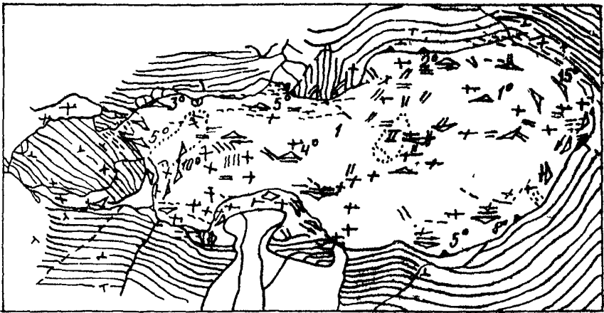
Рис. 2. Карта трещиноватости (по Т.В.Плотниковой): [Symbol: cross] - поперечные трещины; [Symbol: arrow] - продольные трещины; [Symbol: triangle] - полосы течения наклонные; [Symbol: diamond] - полосы течения горизонтальные; [Symbol: left arrow] - наклон горизонтальной поверхности; [Symbol: vertical arrow] - вертикальный контакт; [Symbol: hatched] - простирание вмещающих пород; [Symbol: wavy] [Symbol: dotted] [Symbol: cross-hatched] - жильные породы
