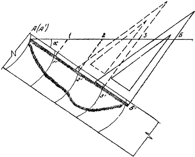
Рис. 8. Перенос отметок на план способом треугольника
