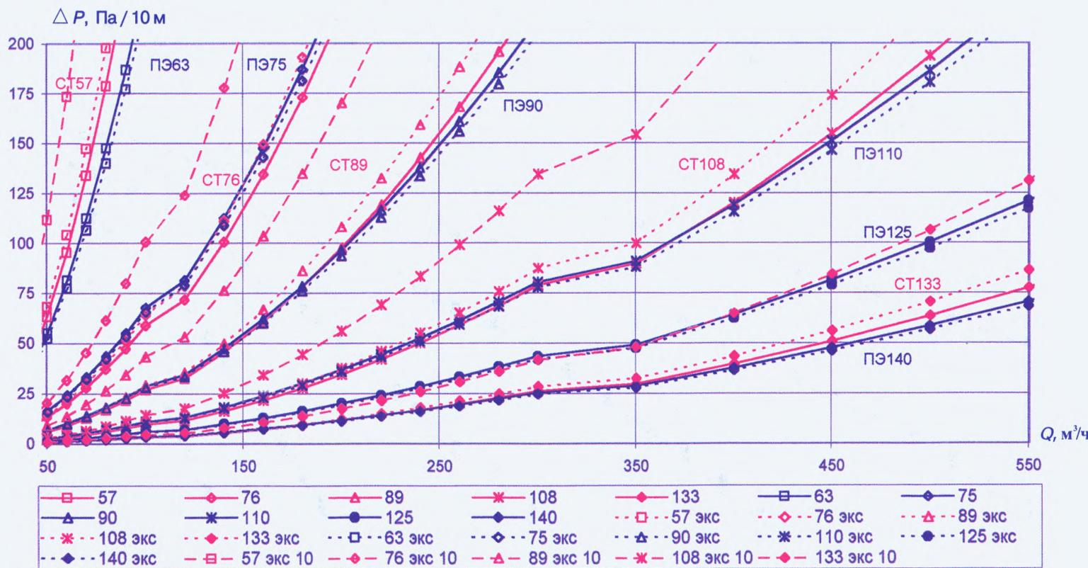
Удельные потери давления для стальных и полиэтиленовых труб (новых и бывших в эксплуатации) низкого давления
