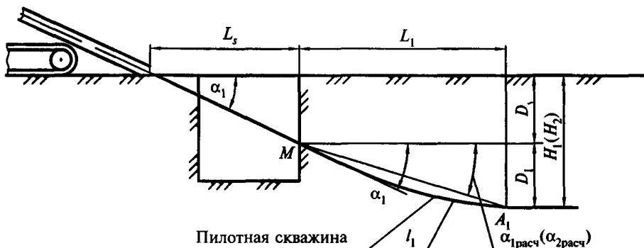
Рисунок Л.2 — Схема забуривания пилотной скважины
