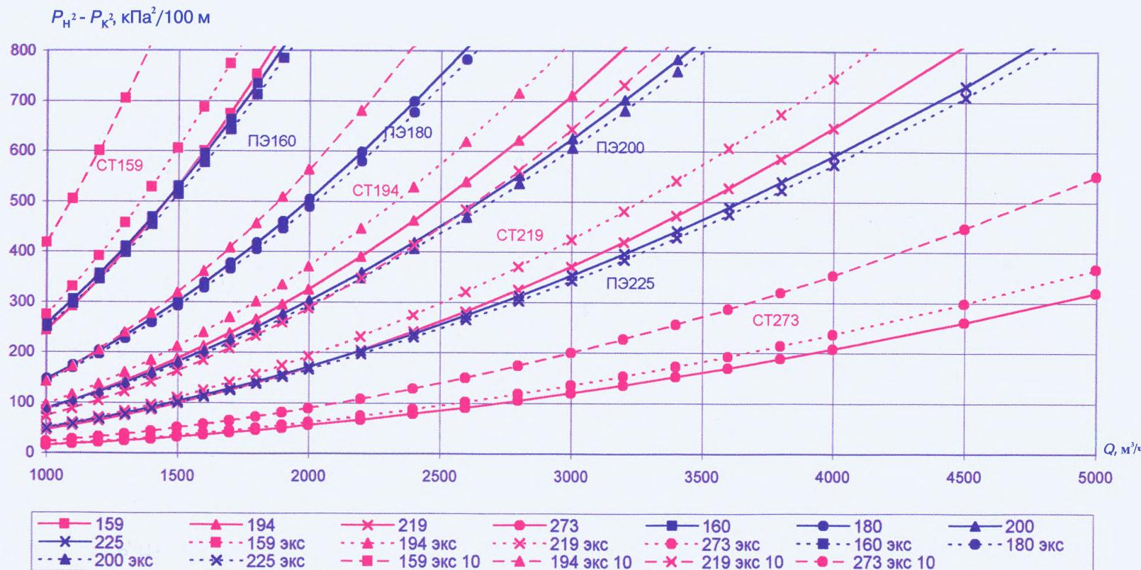
Удельные потери давления для стальных и полиэтиленовых труб (новых и бывших в эксплуатации) низкого давления
