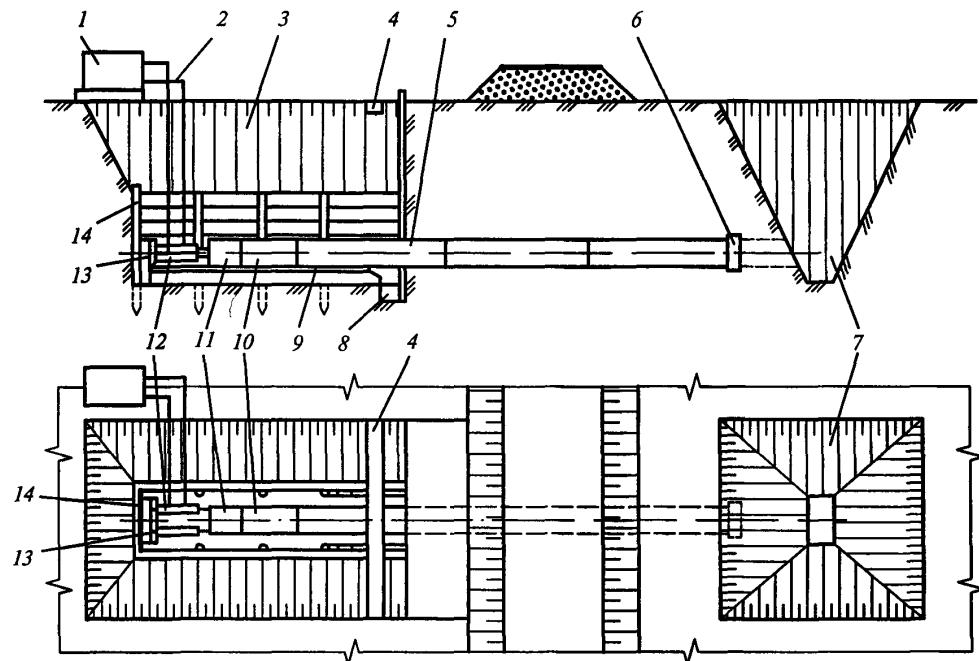
1 — насосная станция, 2 — газопровод, 3 — рабочий котлован, 4 — водоотводной лоток, 5 — защитный футляр, 6 — лобовая обделка (нож), 7 — приемный котлован, 8 — приемник для сварки защитного футляра, 9 — направляющая рама, 10 — нажимной патрубок, 11 — нажимная заглушка, 12 — гидродомкраты, 13 — башмак, 14 — упорная стена
