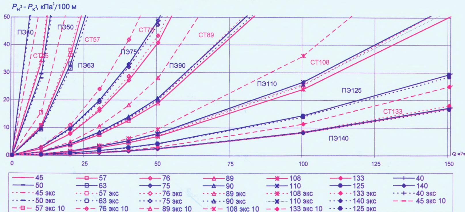
Удельные потери давления для стальных и полиэтиленовых труб (новых и бывших в эксплуатации) среднего давления
