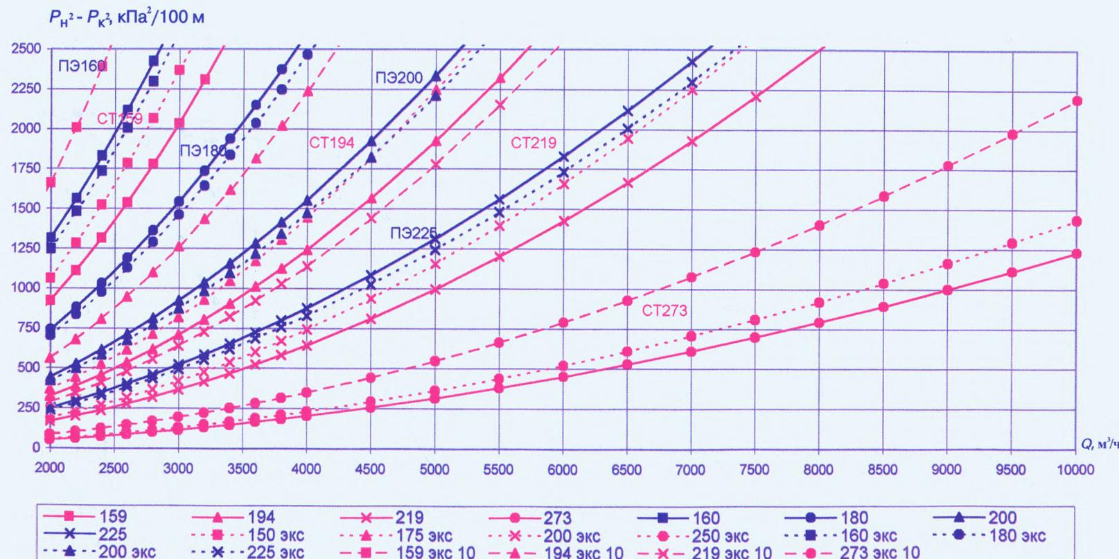
Удельные потери давления для стальных и полиэтиленовых труб (новых и бывших в эксплуатации) высокого давления
