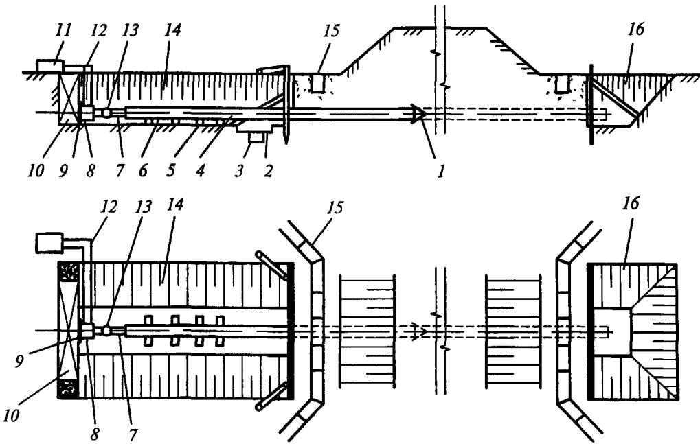
1 — конусный наконечник, 2 — приемок для сварки звеньев футляра в потолочном положении, 3 — приемок для стока грунтовых вод, 4 — труба-футляр, 5, 6 — направляющая рама, 7 — набор нажимных патрубков, 8 — гидродомкрат, 9 — опорный башмак, 10 — упорная стенка, 11 — насосная станция, 12 — трубы высокого давления, 13 — торцевая нажимная заглушка, 14 — рабочий котлован, 15 — водоотводной лоток, 16 — приемный котлован
