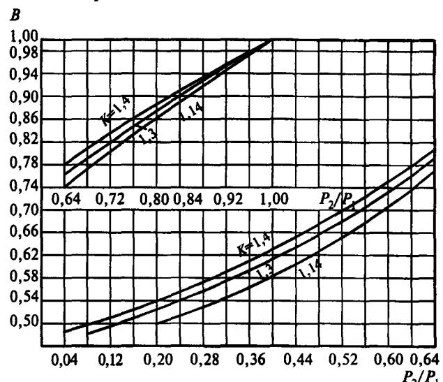
Рисунок 6 — Зависимость коэффициента  $B$  от  $P_2/P_1$ .
