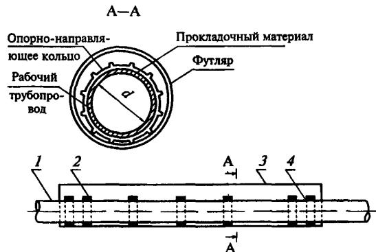
1 — газопровод, 2 — опорно-направляющее кольцо, 3 — футляр, 4 — прокладочный материал
