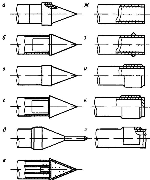
а, б, в — конусные наконечники, ж — конусный наконечник с эксцентрикситетом, з — конусный наконечник с отверстиями для увлажнения грунта, и — открытый конец кожуха с кольцом из круглой стали, и — кольцевой нож с наружным скосом режущих кромок, к — кольцевой нож с наружным скосом режущих кромок и приварной заглушкой, л — нож серпоподобного сечения с приварной заглушкой
