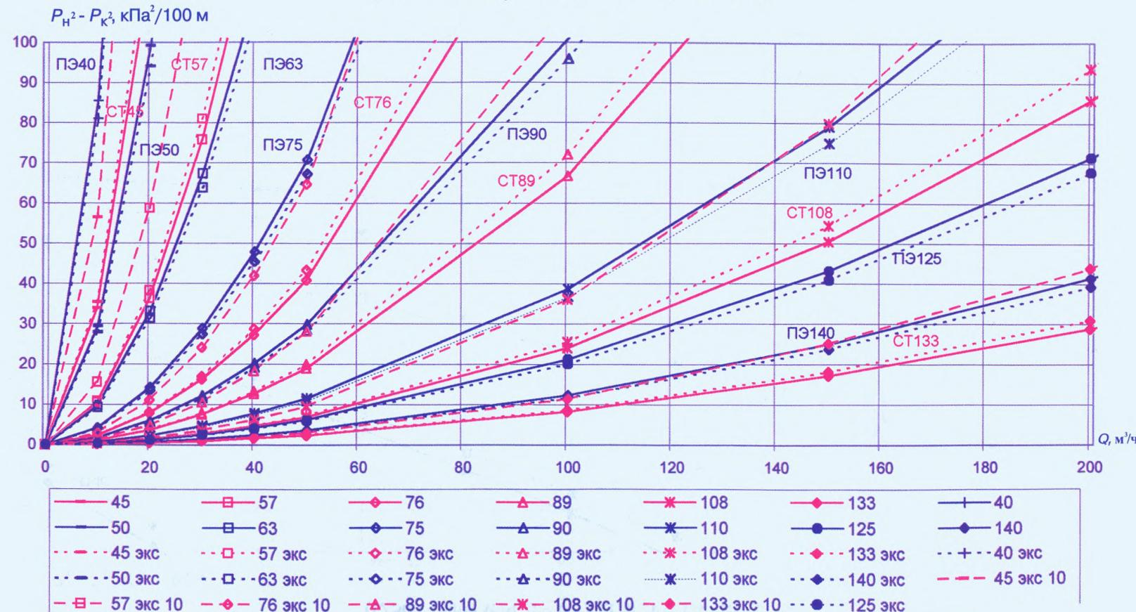
Удельные потери давления для стальных и полиэтиленовых труб (новых и бывших в эксплуатации) высокого давления
