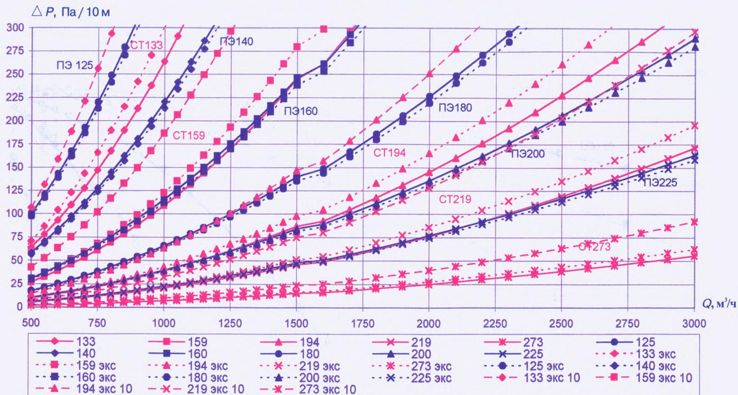
Удельные потери давления для стальных и полиэтиленовых труб (новых и бывших в эксплуатации) низкого давления
