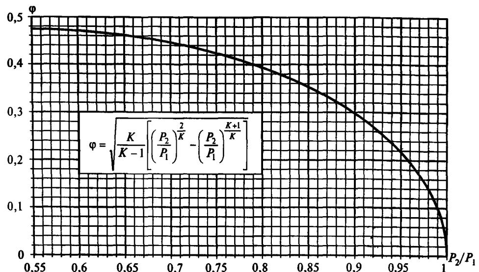
Если в паспортных данных регулятора приведена величина расхода газа при максимальном давлении с соответствующей плотностью, то при других значениях  $P$  — входного давления и  $\rho_0$  — плотности пропускная способность регулятора может быть определена по формуле (19)
