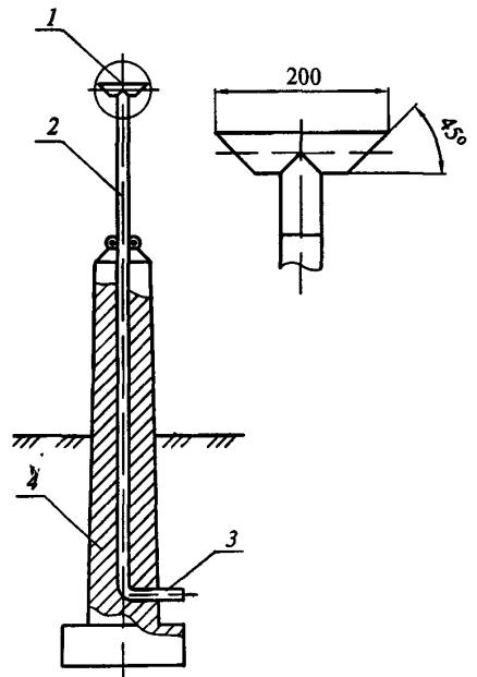
1 — оголовник; 2 — вытяжная труба, 3 — отводная труба,
