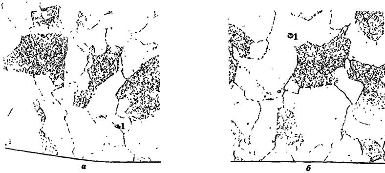
Рис.7. Микроструктура стали 12X1MΦ.
