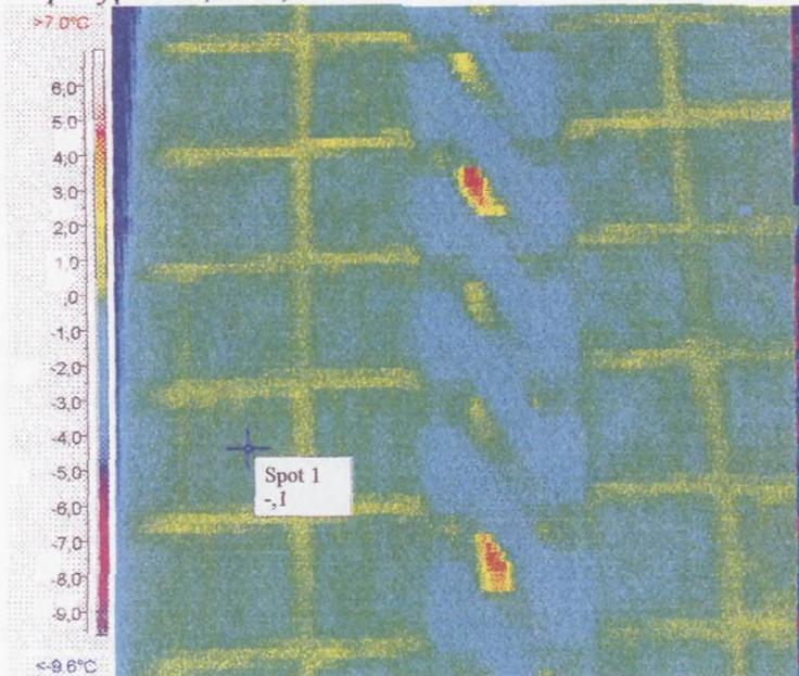
Рис.1.6 Термограмма стены панельного здания без оконных проёмов. Участок с температурой -3 °С может быть принят как базовый.
