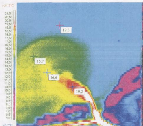
Рис. 6.1 Распределение температур на поверхности пруда охладителя ТЭЦ
