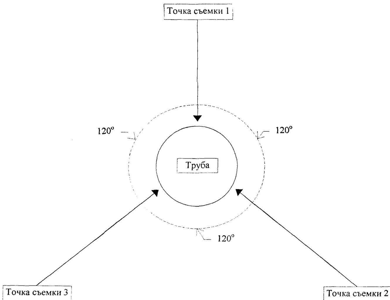
Рис.4.1 Схема тепловизионной съемки дымовой трубы.
