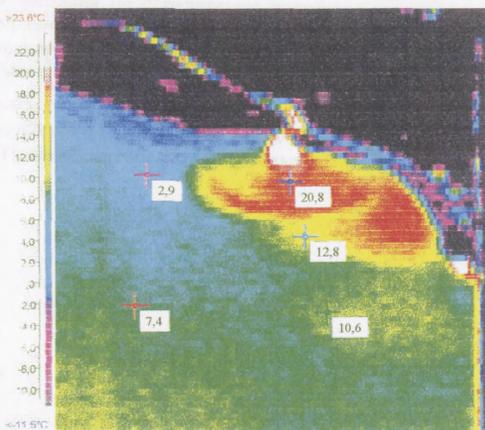
Рис. 6.2 Распределение температур на поверхности пруда охладителя ТЭЦ
