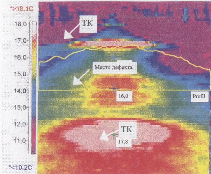
Рис. 5.8 Участок подземной теплотрассы с нарушенной изоляцией.
