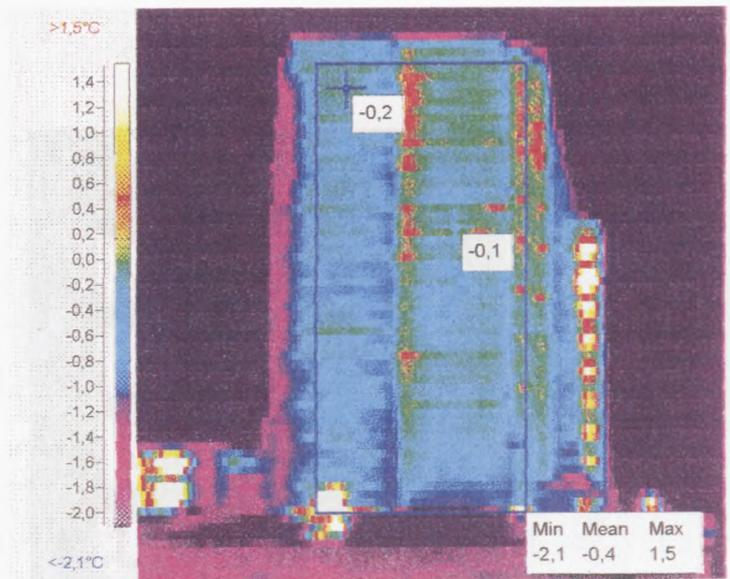
Рис. 1-9 Торцевая часть 9-ти этажного здания. Поверхность с  $t = -0,4 \text{ }^\circ\text{C}$ , можно принять за базовый участок. Красная полоса в центре здания вызвана тепловым отражением.
