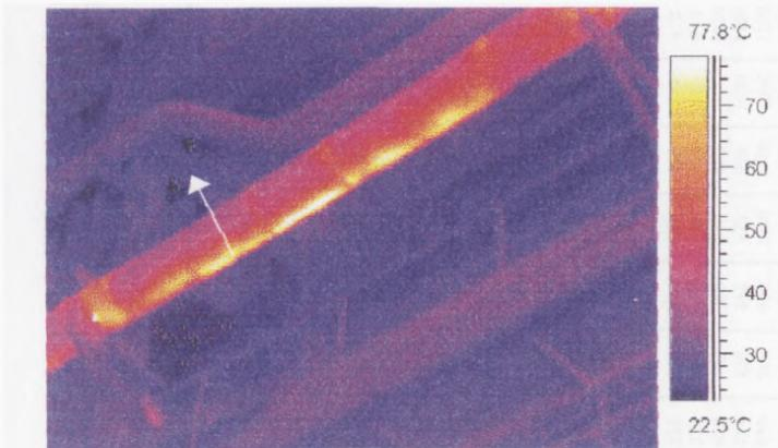
Рис.2.3 Участок паропровода с повышенными теплотерями.
