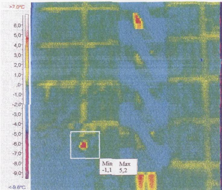
Рис.1.5 Термограмма стены панельного здания без оконных проёмов. В левой части видно место воздухопроница- ния через межпанельный шов. (Соответствует темпе- ратуре +5,2 °С)
