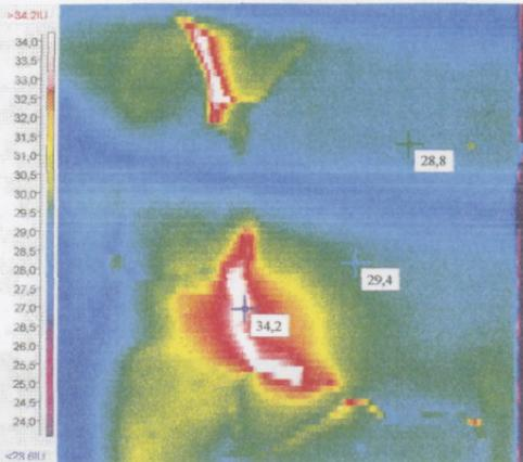
Рис.2.1 Разрушение футеровки котла (трещина)
