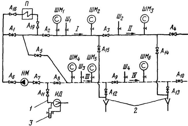
Рис. I. Принципиальная гидропневматическая схема промываемых участков тепловой сети:
