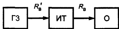
Рисунок 21 — Схема измерения верхней граничной частоты канала передачи сигналов изображения и размаха полного цветового телевизионного сигнала
