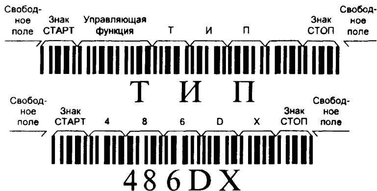
Рисунок Е.2 — Символы штрихового кода, в которых закодированы данные ТИП 486DX
