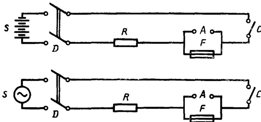
*A* — съемная вставка, используемая для калибровки; *C* — контактор, замыкающий цепь; *D* — выключатель для отключения источника питания; *F* — испытываемый предохранитель; *S* — источник питания, полное сопротивление которого составляет менее 10 % от общего полного сопротивления цепи; *R* — последовательно включенный резистор, отрегулированный для получения необходимого ожидаемого тока
