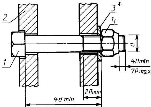
\* Провертывание шайбы не допускается.
