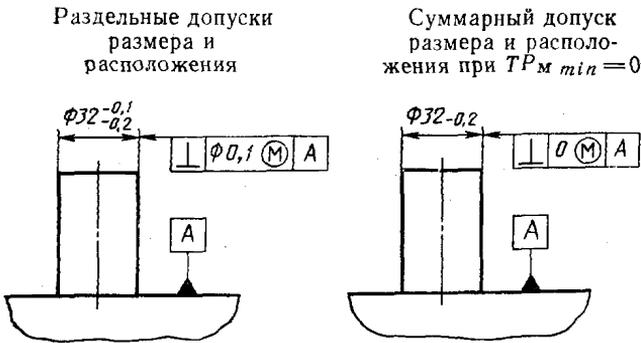
5.4. Соотношение между отклонениями размера и расположения в пределах суммарного допуска (при нулевых зависимых допусках расположения) не регламентируют. При необходимости оно может быть установлено в технологической документации с учетом особенностей процесса изготовления путем назначения поэлементного предела максимума материала для местного размера или размера по сопряжению ( $d_{MMC}$  на черт. 2). Контроль
