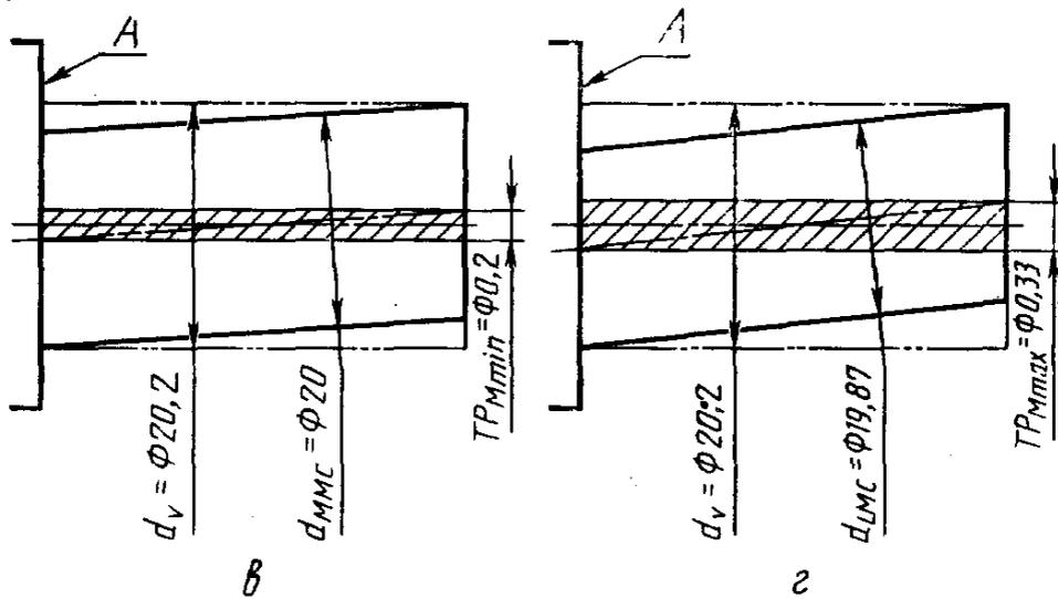
Действительные значения зависимого допуска перпендикулярности оси при различных значениях диаметра выступа по сопряжению приведены в таблице на черт. 6 и графически показаны на диаграмме (черт. 6б).
