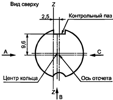
Определение линии Z-Z
