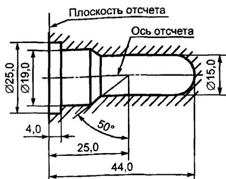
Рисунок 2 — Максимальный внешний контур лампы <sup>3)</sup>
