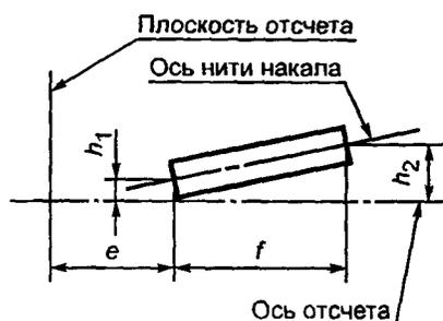
Рисунок 6 — Допустимое смещение оси нити накала (только для эталонных ламп накаливания) <sup>9)</sup>
