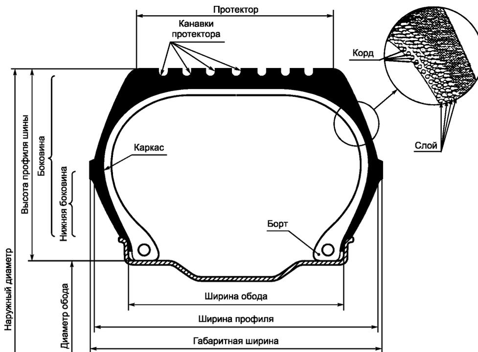
Рисунок 1 — Конструкция пневматической шины (см. раздел 2 настоящих Правил)
