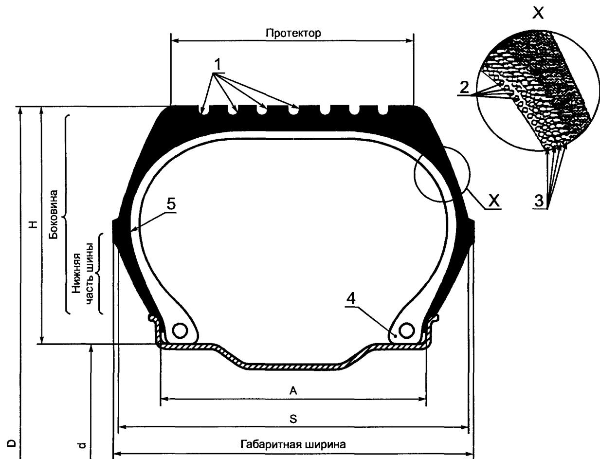
$D$  — наружный диаметр;  $d$  — номинальный диаметр обода;  $H$  — высота профиля;  $A$  — ширина обода;  $s$  — ширина профиля;  $I$  — канавки протектора; 2 — корд; 3 — слой; 4 — борт; 5 — каркас
