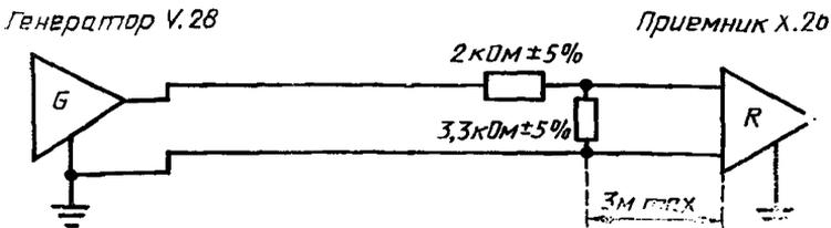
Рисунок С.2 — L-образный удлинитель для защиты приемника Х.26
