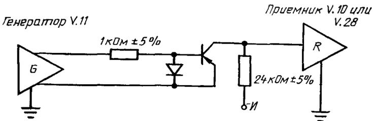
Рисунок D.1 — L-образный удлинитель для защиты приемника V.10 или V.28
