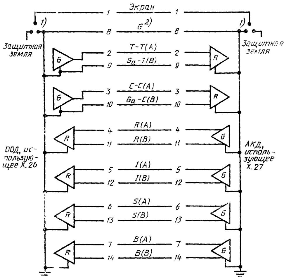
1) Контакт 1 предназначен для соединения экранов между спаренными частями экранированного интерфейсного кабеля. Экран может быть подсоединен либо к защитной земле, либо к сигнальной земле на стороне ООД или АКД, или на обеих сторонах в соответствии с национальными правилами.
