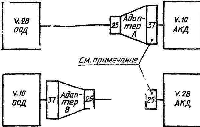
*Примечание* — Рекомендация V.24 МККТТ определяет, что соединитель необязательно должен быть физически подключен к АКД
