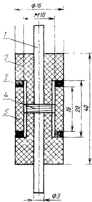
1—электрод; 2—втулки из фторопласта; 3—прокладки из химически стойкой резины по ГОСТ 7338—77; 4—образцы испытуемого упаковочного материала; 5—муфта из фторопласта.
