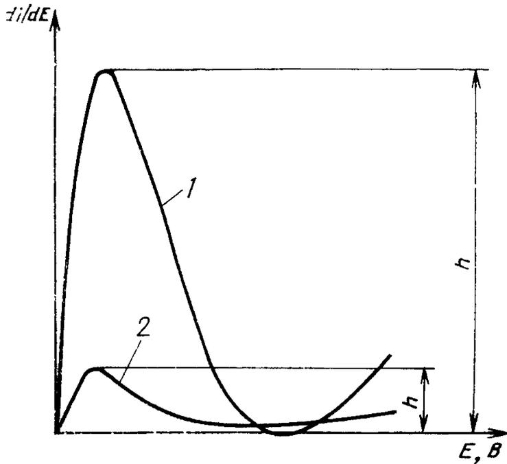
1—поляризационная характеристика электродов в отсутствии образцов упаковочного материала; 2—поляризационная характеристика электродов в присутствии образцов противокоррозионной бумаги с ингибитором МЭА.
