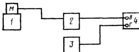
1—поверяемый хронометр; 2—преобразователь звуковых сигналов с микрофоном *M*; 3—кварцевый синхронометр; 4—электронно-счетный частотомер
