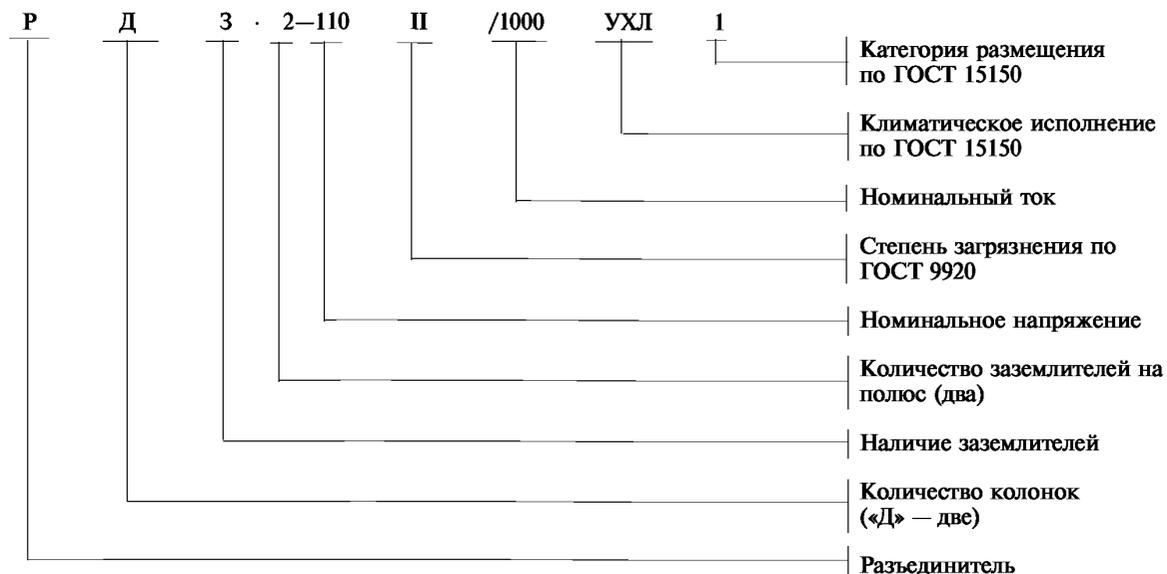
1.3.4. Условное обозначение отдельно стоящего заземлителя устанавливают по следующей структуре:
