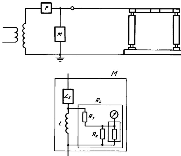
$F$  — фильтр;  $M$  — измерительный блок;  $R_L$  — эквивалентное сопротивление  $R_1$ , соединенное последовательно в комбинации с сопротивлением  $R_2$ , соединенным параллельно с эквивалентным сопротивлением измерительной установки;  $Z_s$  — может быть конденсатором или цепью, состоящей из конденсатора и индуктивной катушки, соединенных последовательно;  $L$  — используется для шунтирования токов промышленной частоты и для компенсации паразитной емкости при измерительной частоте
