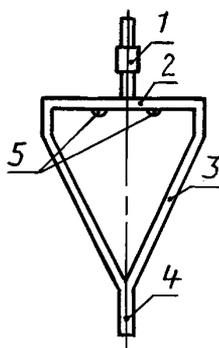
1 — противовес для регулирования собственной частоты;
