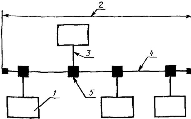
1 — станция; 2 — коаксиальный кабельный сегмент (макс. 185 м); 3 — кабель ИМС (макс. 50 м); 4 — коаксиальный кабель; 5 — МСС и соединение с коаксиальным кабелем (макс. 30 м на сегмент)
