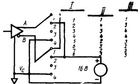
I — неисправное состояние; II — переключение на провод A; III — установка на провод B
