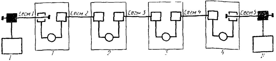
I — станция 1; II — станция 2; 1 — повторительная установка 1; 2 — повторительная установка 2; 3 — повторительная установка 3; 4 — повторительная установка 4
