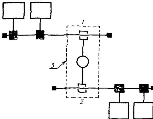
1 — коаксиальный сегмент 1; 2 — коаксиальный сегмент 2; 3 — повторительная установка
