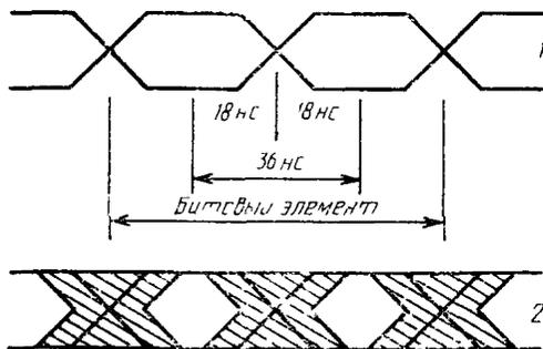
1 — идеальная форма сигнала на приемнике; 2 — допустимая форма сигнала на приемнике
