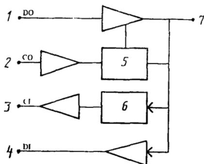
1 — вывод данных, 2 — вывод управления; 3 — ввод управления; 4 — ввод данных; 5 — изоляция; 6 — качество сигнала; 7 — среда
