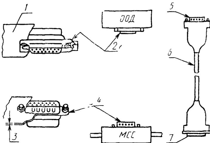
1 — для надежного срабатывания скользящей защелки панель должна располагаться на уровне с фланцем или сзади его; 2 — гнездовой соединитель со скользящей защелкой; 3 — панель толщиной 1 мм или две шайбы по 0,70 мм под шестигранной гайкой; 4 — штепсельный соединитель с фиксирующим штифтом. 5 — вилка, 6 — кабель ИМС, 7 — гнездо
