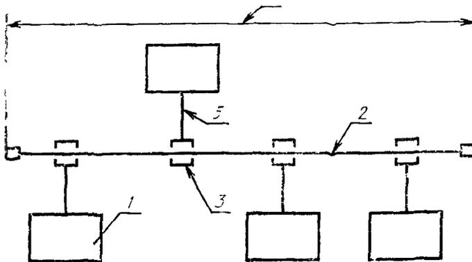
1 — станция, 2 — коаксиальный кабель, 3 — МСС и соединение с коаксиальным кабелем (макс 100 м на сегмент), 4 — коаксиальный кабельный сегмент (макс 500 м) 5 — кабель ИМС (макс 50 м)
