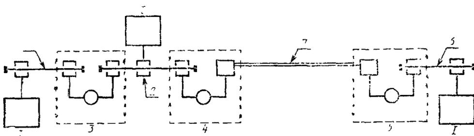
1 — станция, 1 — коаксиальный сегмент 1; 2 — коаксиальный сегмент 2; 3 — повторительная установка 1; 4 — повторительная установка 2; 5 — повторительная установка 3; 6 — коаксиальный сегмент 3; 7 — два двухпунктовых соединительных сегмента: 5140 нс
