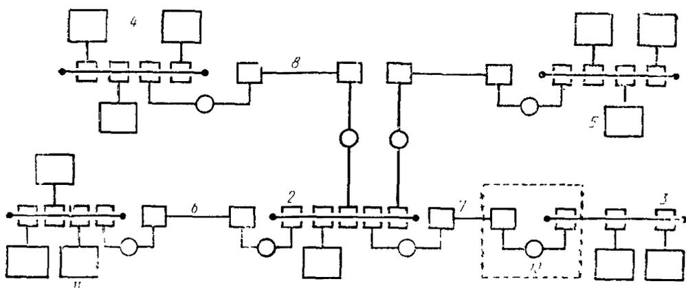
1 — коаксиальный сегмент 1; 2 — коаксиальный сегмент 2; 3 — коаксиальный сегмент 3; 4 — коаксиальный сегмент 4; 5 — коаксиальный сегмент 5; 6 — соединительный сегмент 1; 7 — соединительный сегмент 2; 8 — соединительный сегмент 3; 9 — соединительный сегмент 4; 10 — повторительная установка; 11 — станция
