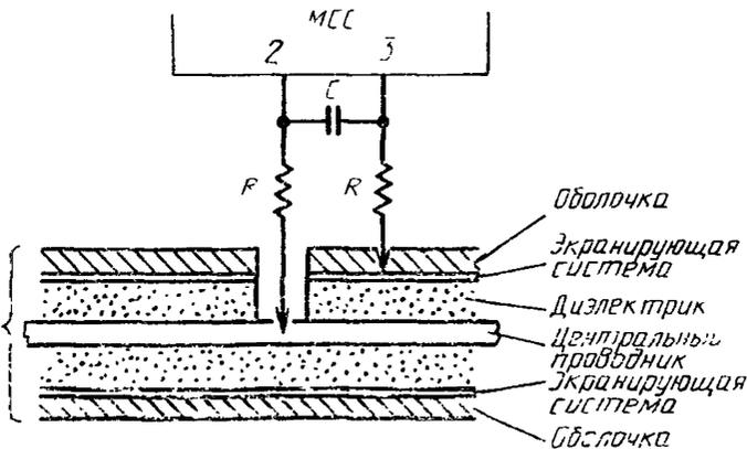
$C$  — емкостная нагрузка (см. п. 8.5.3.1);  $R$  — контактное сопротивление (см. п. 8.5.3.1); 1 — коаксиальный кабель; 2 — сигнал; 3 — общий провод
