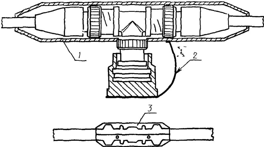
1 — изоляция корпуса обжатием специальной заготовки, 2 — оболочка для изоляции вилки «Т» соединителя, надвигаемая со стороны ООД, 3 — изолирующая оболочка
