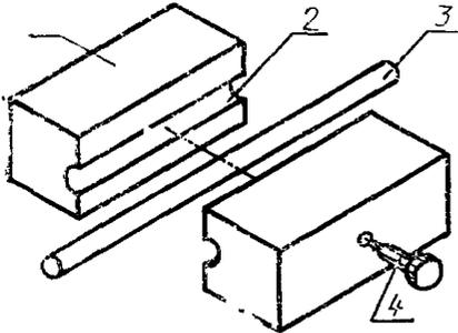
1 — корпус ответвителя; 2 — кабельный желоб; 3 — коаксиальный кабель; 4 — ответвительный болт
