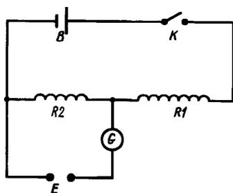
$B$  — батарея 1,5 В;  $K$  — ключ;  $R1$  — сопротивление 5000 Ом;  $R2$  — сопротивление 100 Ом;  $G$  — стрелочный гальванометр;  $E$  — ячейка с электродами
