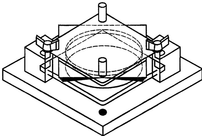
Рисунок 3 — Прибор для определения масловпитываемости бумаги
