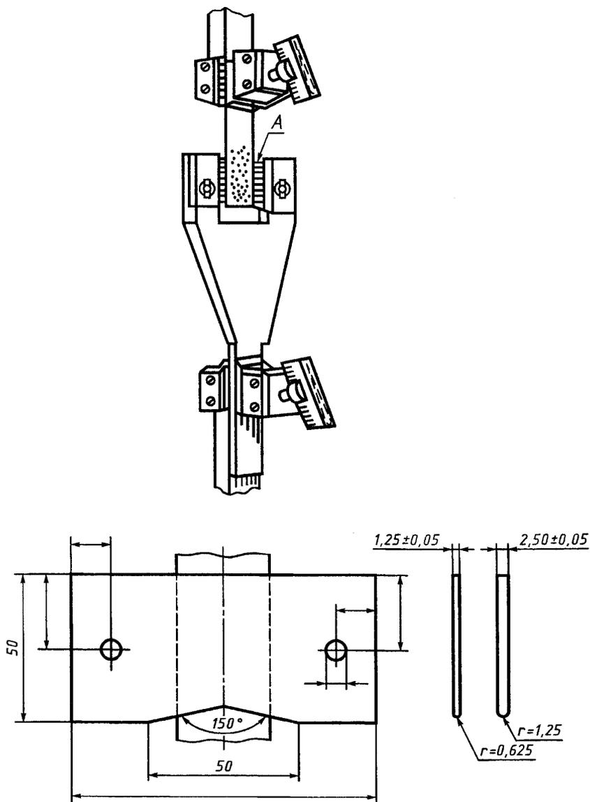
Рисунок 1 — Приспособление для надрыва кромки бумаги
