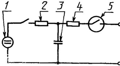
1 — источник высокого напряжения; 2 — зарядный резистор  $R_3$ ; 3 — накопительный конденсатор  $C_n$ ; 4 — разрядный резистор  $R_p$ ; 5 — разрядный ключ
