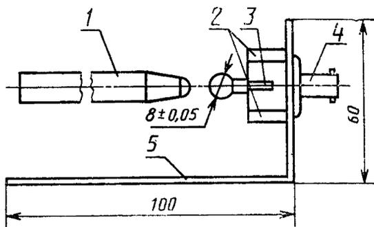
1 — разрядный наконечник; 2 — резисторы, расположенные по кругу; 3 — согласующий резистор; 4 — коаксиальный соединитель; 5 — металлическая пластина (при проверке ИГ соединяется с его клеммой заземления без заземляющего провода).
