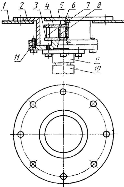
1 — стенка камеры Фарадея; 2 — корпус; 3 — диск; 4 — входной диск; 5 — входной электрод; 6 — шпилька; 7 — нагрузочный резистор; 8 — согласующий резистор; 9 — выходной коаксиальный соединитель (розетка); 10 — выходной коаксиальный соединитель (вилка); 11 — выходной фланец
