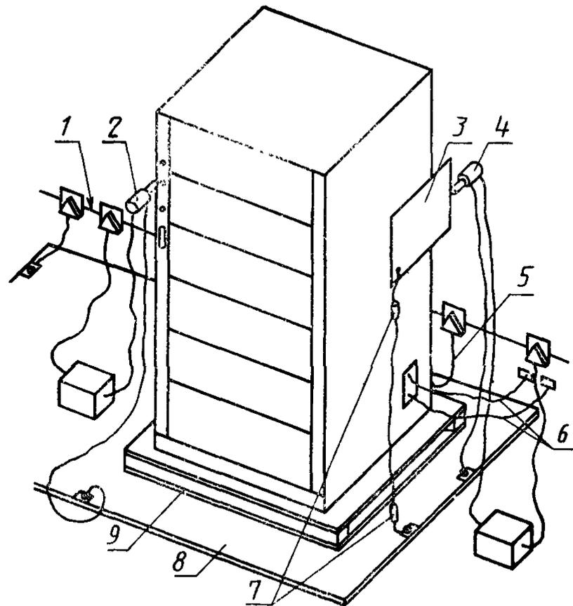
1 — защитное заземление; 2 — положение ИГ при воздействии прямыми разрядами; 3 — вертикальная плоскость связи; 4 — положение ИГ при воздействии непрямыми разрядами на вертикальную плоскость связи; 5 — кабель питания ИТС; 6 — кабели ввода-вывода (сигналов данных, связи и управления); 7 — резисторы 470 кОм; 8 — плоскость заземления; 9 — изоляционная опора
