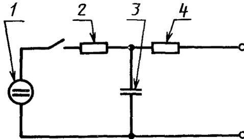
1 — источник высокого напряжения; 2 — зарядный резистор  $R$ ; 3 — накопительный конденсатор  $C_H$ ; 4 — разрядный резистор  $R_p$
