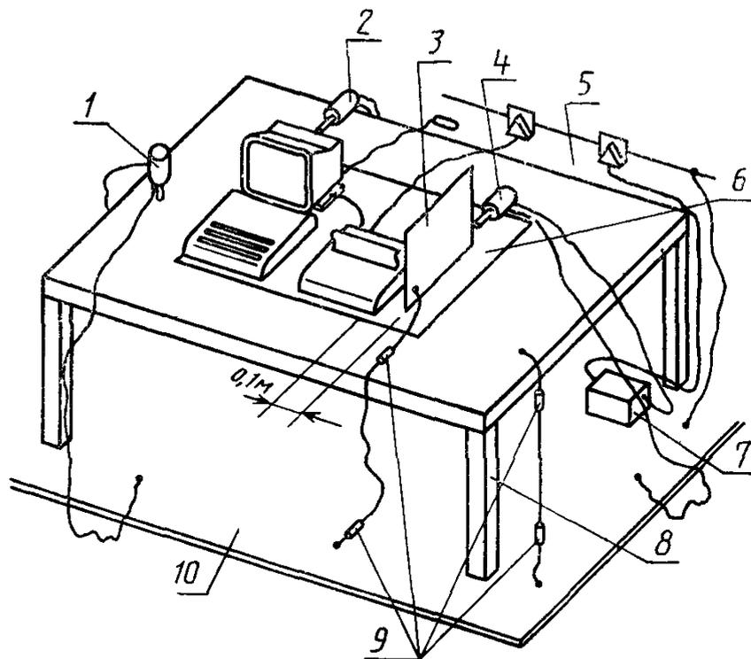
1 — положение ИГ при воздействии непрямыми разрядами на горизонтальную плоскость связи; 2 — положение ИГ при воздействии прямыми разрядами на ИТС; 3 — вертикальная плоскость связи; 4 — положение ИГ при воздействии непрямыми разрядами на вертикальную плоскость связи; 5 — горизонтальная плоскость связи; 6 — изоляционный слой; 7 — источник высокого напряжения; 8 — деревянный стол; 9 — резисторы 470 кОм; 10 — плоскость заземления
