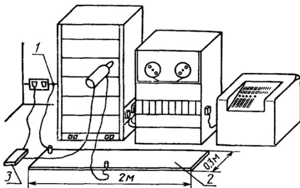
1 — защитное заземление; 2 — плоскость заземления; 3 — источник высокого напряжения
