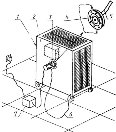
1 — камера Фарадея; 2 — передняя стенка; 3 — датчик тока; 4 — входной электрод; 5 — коаксиальный кабель к осциллографу; 6 — заземляющий провод ИГ; 7 — источник высокого напряжения
