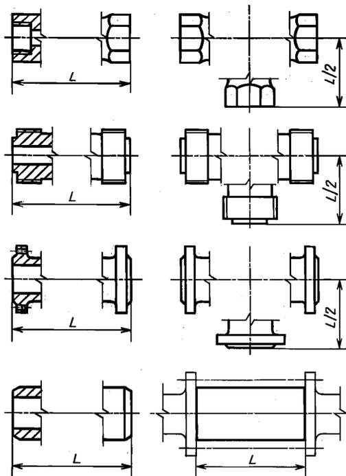
**Строительные длины муфтовых и штуцерных шаровых кранов**
