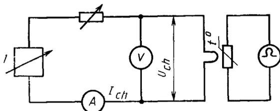
*I* — стабилизированный источник регулируемого напряжения (постоянного тока)
