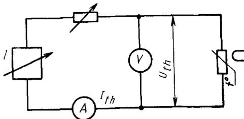
*I* — стабилизированный источник регулируемого напряжения (постоянного тока)
