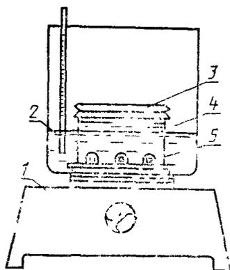
1—нагревающее устройство; 2—водяная или масляная баня; 3—полимерная пленка, закрепленная с помощью эластичного шнура; 4—химический стакан, содержащий раствор двухлористой меди; 5—образец для испытаний
