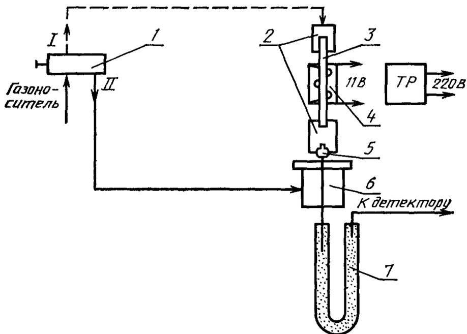
1 — край-дозатор; 2 — соединительная силиконовая трубка; 3 — концентратор; 4 — термоячейка; 5 — инъекционная игла; 6 — испаритель; 7 — хроматографическая колонка
