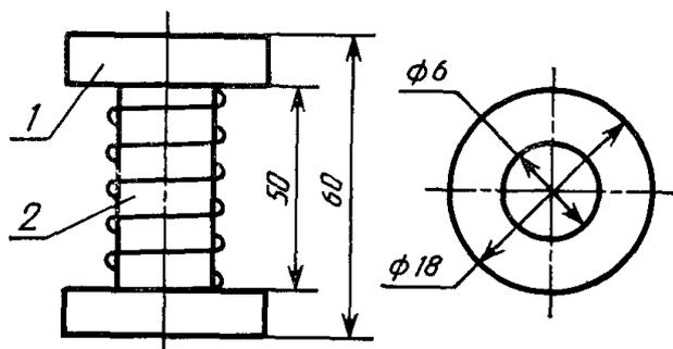
1 — корпус; 2 — нагревательный элемент
