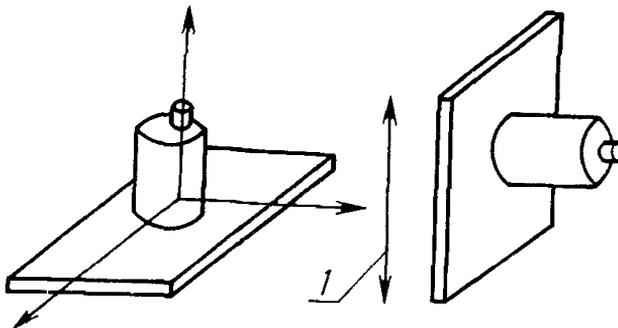
*l*—направления движения стола вибростенда или ударного стенда
