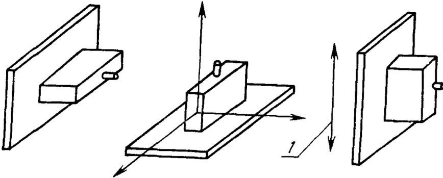
*l*—направления движения стола вибростенда или ударного стенда
