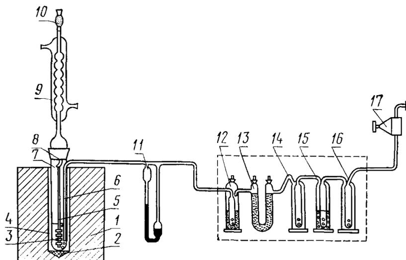
1—термостат; 2—асбест; 3—стеклянные разделительные трубки; 4—металлические пластины; 5—стержень с крючком; 6—барбатер газа; 7—стеклянный реактор; 8—перекладина холодильника для подвешивания стержня; с металлическими пластинами; 9—восьмишариковый холодильник; 10—трубка с ватой гигроскопической; 11—реометр; 12—склянка с сухой ватой; 13—U-образная трубка с хлористым кальцием и силикагелем-индикатором; 14 и 16—промежуточные пустые склянки; 15—склянка с серной кислотой; 17—редуктор низкого давления
