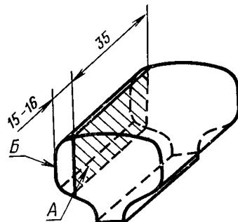
Примечание. Отклонение от параллельности поверхностей А и Б—не более 0,1 мм
