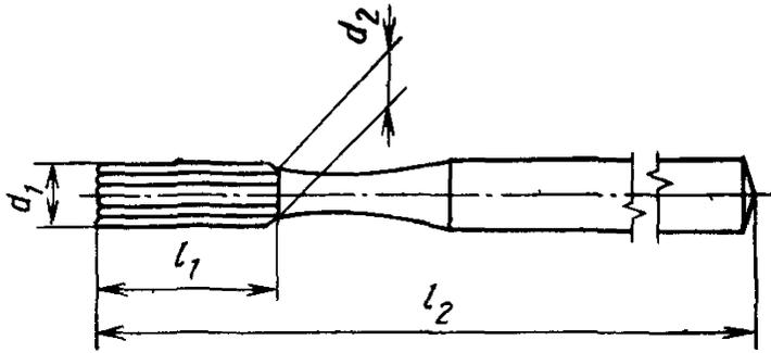
Угол скоса головки  $< 2^\circ$
