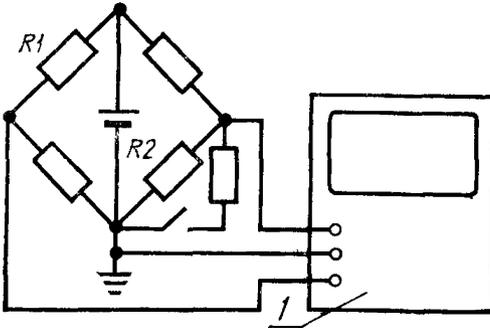
1 — двухканальный электроннолучевой или цифровой осциллограф
