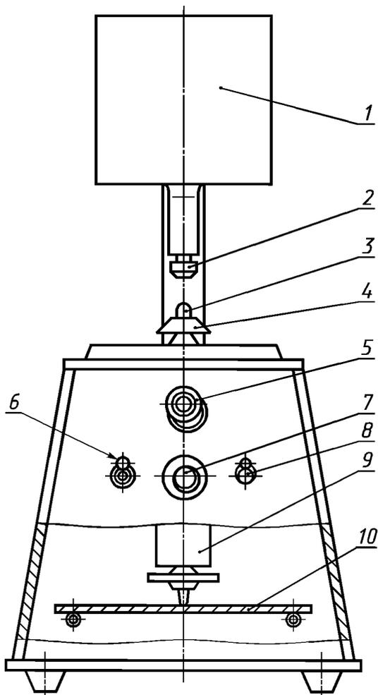
1 — механизм привода; 2 — пуансон; 3 — исследуемая гранула; 4 — рабочий столик; 5 — индикатор включения; 6, 8 — тумблер; 7 — кнопка; 9 — дифференциальный трансформатор; 10 — пружина
