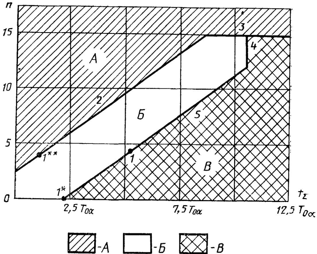
A—принимают отрицательное решение; B—продолжают испытания; B—принимают положительное решение; 1—ожидаемая точка принятия решения при  $t_{\Sigma 0} = 5,1 \cdot T_{0\alpha} = 5,1 \cdot 10^4$  ч; 2, 3—принимают отрицательное решение; 4, 5—принимают положительное решение. Ожидаемое время до принятия решения (точка 1) составляет  $5,1 \cdot T_{0\alpha} = 5,1 \cdot 10^4$  ч; n—суммарное число учитываемых отказов.
