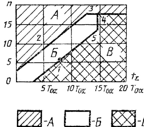
$A$ —принимают отрицательное решение;  $B$ —продолжают испытания;  $B$ —принимают положительное решение;  $t_{\Sigma}$ —суммарное учитываемое время испытаний;  $1$ —ожидаемая точка принятия решения, когда  $t_{\Sigma 0} = 7,6 \cdot T_{0\alpha}$ ;  $2$ ,  $3$ —принимают отрицательное решение;  $4$ ,  $5$ —принимают положительное решение;  $n$ —суммарное число учитываемых отказов.
