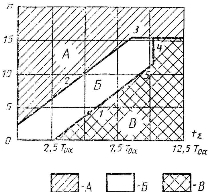
A—принимают отрицательное решение; B—продолжают испытания; B̄—принимают положительное решение;  $t_{\Sigma}$ —суммарное учитываемое время испытания; 1—ожидаемая точка принятия решения, когда  $t_{\Sigma 0} = 5,1 T_{0\alpha}$ ; 2, 3—принимают отрицательное решение; 4, 5—принимают положительное решение; n—суммарное число учитываемых отказов.
