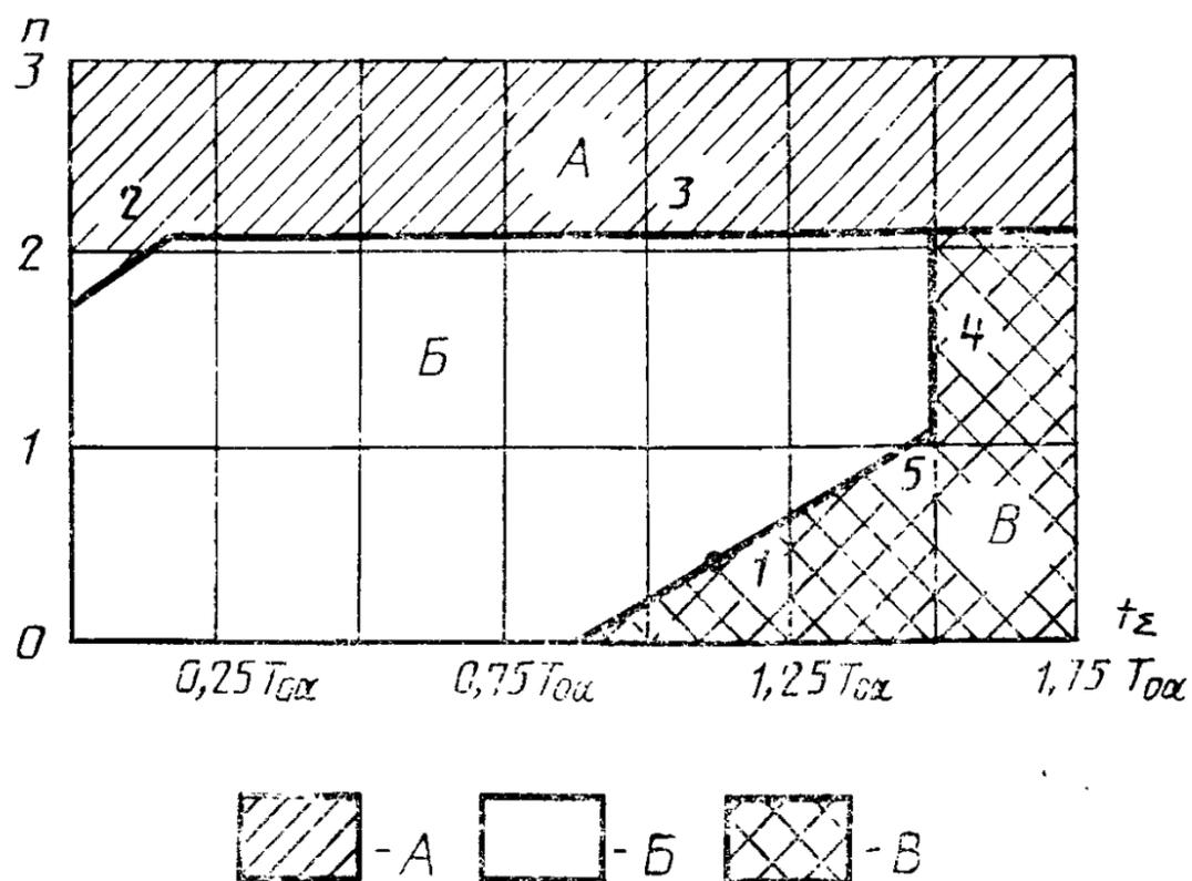
А—принимают отрицательное решение; Б—продолжают испытания; В—принимают положительное решение;  $t_{\Sigma}$ —суммарное учитываемое время испытания, 1—ожидаемая точка принятия решения, когда  $t_{\Sigma_0} = 1,1 \cdot T_{0\alpha}$ ; 2, 3—принимают отрицательное решение; 4, 5—принимают положительное решение;  $n$ —суммарное число учитываемых отказов.
