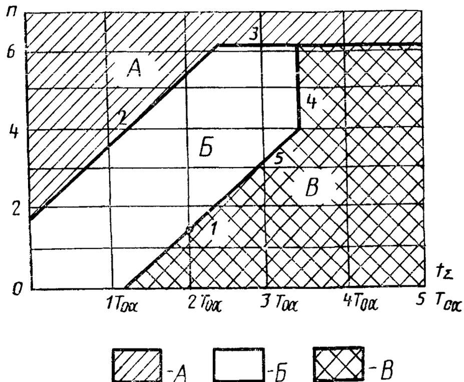
A—принимают отрицательное решение; B—продолжают испытания; B—принимают положительное решение;  $t_{\Sigma 0}$ —суммарное учитываемое время испытания; 1—ожидаемая точка принятия решения, когда  $t_{\Sigma 0} = 2T_{0\alpha}$ ; 2, 3—принимают отрицательное решение; 4, 5—принимают положительное решение;  $n$ —суммарное число учитываемых отказов
