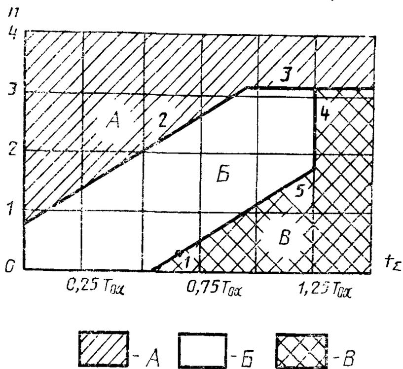
A—принимают отрицательное решение; B—продолжают испытания; B—принимают положительное решение;  $t_\Sigma$ —суммарное учитываемое время испытания;  $t$ —ожидаемая точка принятия решения, когда  $t_{\Sigma_0} = 0,6 \cdot T_{0\alpha}$ ; 1, 2—принимают отрицательное решение; 4, 5—принимают положительное решение;  $n$ —суммарное число учитываемых отказов.
