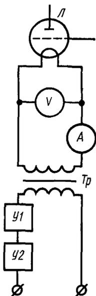
А—амперметр; V—вольтметр; Л—испытываемая лампа; Tr—трансформатор напряжения накала; У1—ограничительное устройство (резистор); У2—прерыватель напряжения
