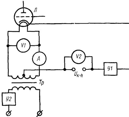
$A$ —амперметр;  $V1, V2$ —вольтметры;  $L$ —испы-
