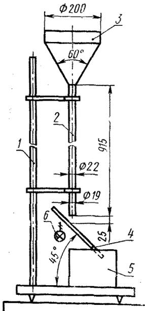
1 — штатив; 2 — направляющая трубка; 3 — воронка; 4 — площадка с креплением для образца и отверстием с вставленным матовым стеклом; 5 — резервуар для падающего песка; 6 — источник света мощностью не более 25 Вт (может быть расположен над площадкой 4)
