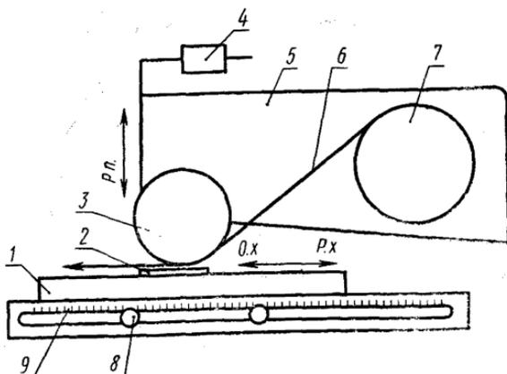
1 — стол; 2 — образец; 3 — лентопротяжной ролик; 4 — сменные грузы; 5 — головка с лентопротяжным механизмом; 6 — лента шлифовальной шкурки; 7 — кассета; 8 — устройство для установления длины хода столика; 9 — шкала
