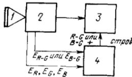
1 — испытательная таблица 3; 2 — камерный канал, 3 — ВКУ по п. 2.1.6; 4 — измеритель совмещения растров по п. 2.1.10
