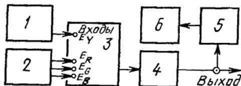
1 — генератор по п. 2.1.7; 2 — генератор по п. 2.1.12; 3 — кодирующее устройство, 4 — последующие блоки канала изображения, 5 — измеритель уровней по п. 2.1.13 или 2.1.15
