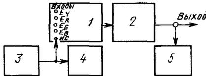
1 — кодирующее устройство 2 — последующие блоки канала изображения 3 — генератор по п. 2.1.7, 4 — осциллограф по п. 2.1.4 или 2.1.5, 5 — анализатор искажений ТИС по п. 2.18
