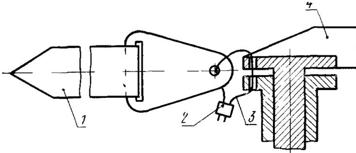
1 — сигнальный флажок; 2 — пломба; 3 — контрольная проволока; 4 — съемный элемент конструкции
