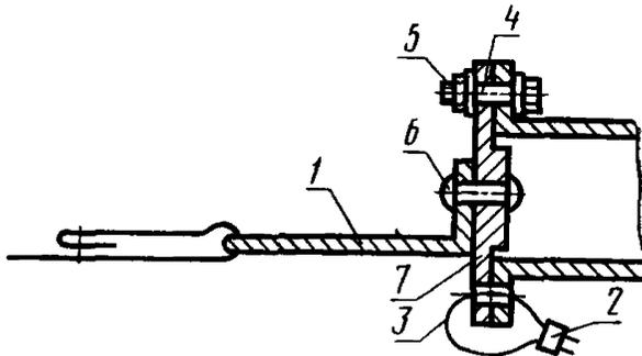
1 — флажок сигнальный; 2 — пломба; 3 — контрольная проволока; 4 — болт; 5 — гайка; 6 — заклепка; 7 — технологическая крышка
