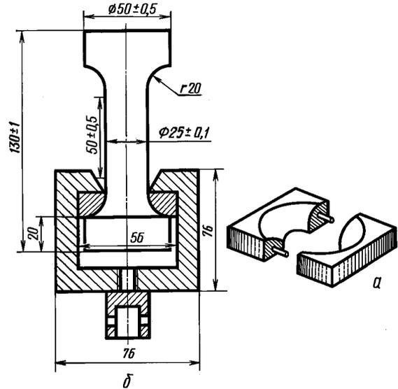
а — разъемный вкладыш; б — захват
