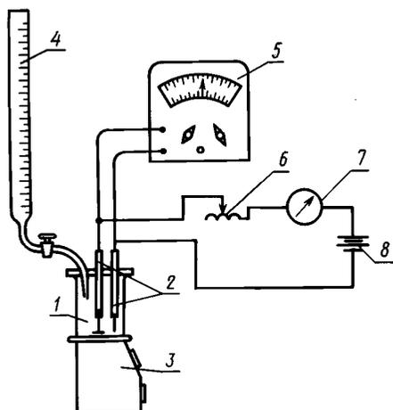
Установка для титриметрического определения алюминия с амперметрической индикацией конца титрования (см. чертеж).
