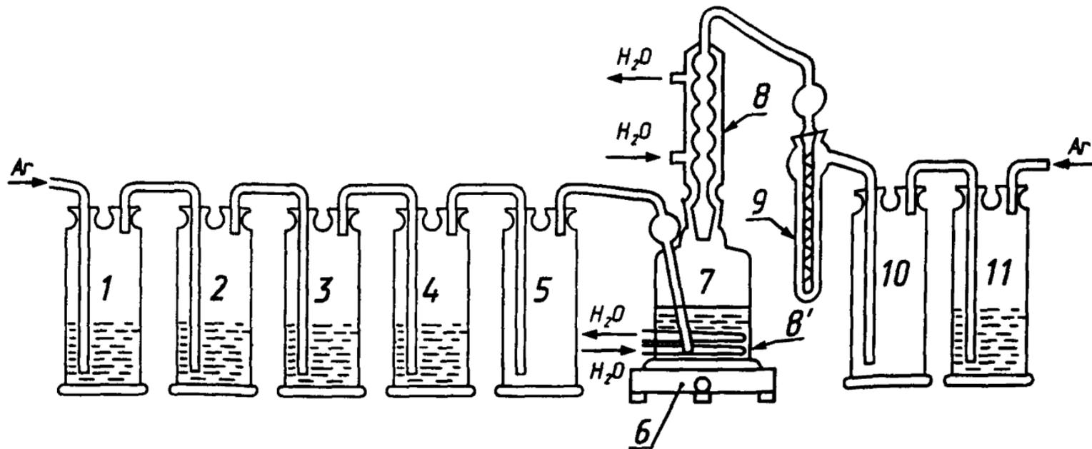
1-4 — барботеры для очистки аргона; 5-10 — предохранительные склянки; 6 — электроплитка с терморегулятором; 7 — реакционный сосуд с восстановительной смесью; 8, 8' — холодильники; 9 — приемник для улавливания сероводорода; 11 — барботер с дистиллированной водой
