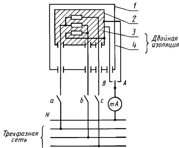
1 — доступная часть; 2 — недоступная часть; 3 — основная изоляция; 4 — дополнительная изоляция
