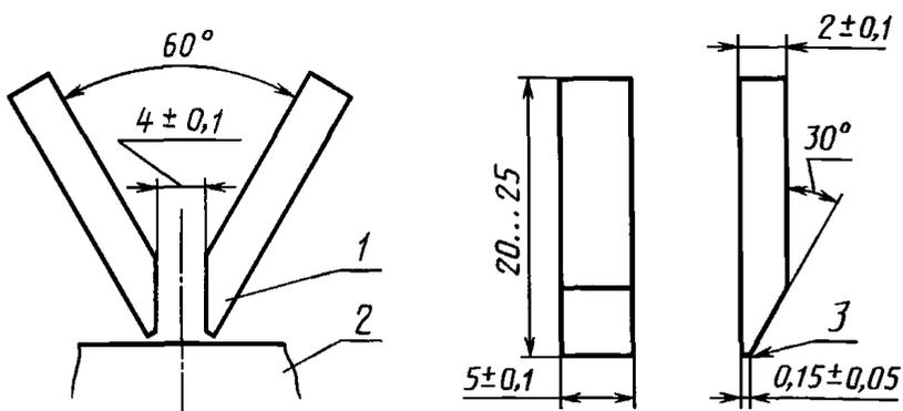
1 — электрод; 2 — образец; 3 — слегка закругленный край
