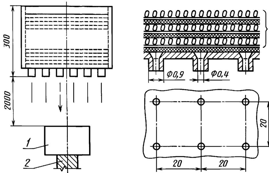
1 — образец; 2 — опора; 3 — слои песка и гравия для регулирования потока воды, причем эти слои должны быть разделены металлической сеткой и промокательной бумагой
