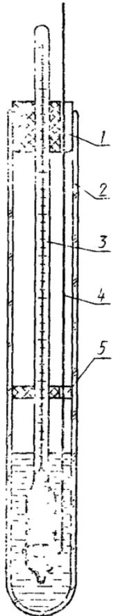
1 — пробка; 2 — пробирка; 3 — термометр; 4 — мешалка; 5 — кольцо
