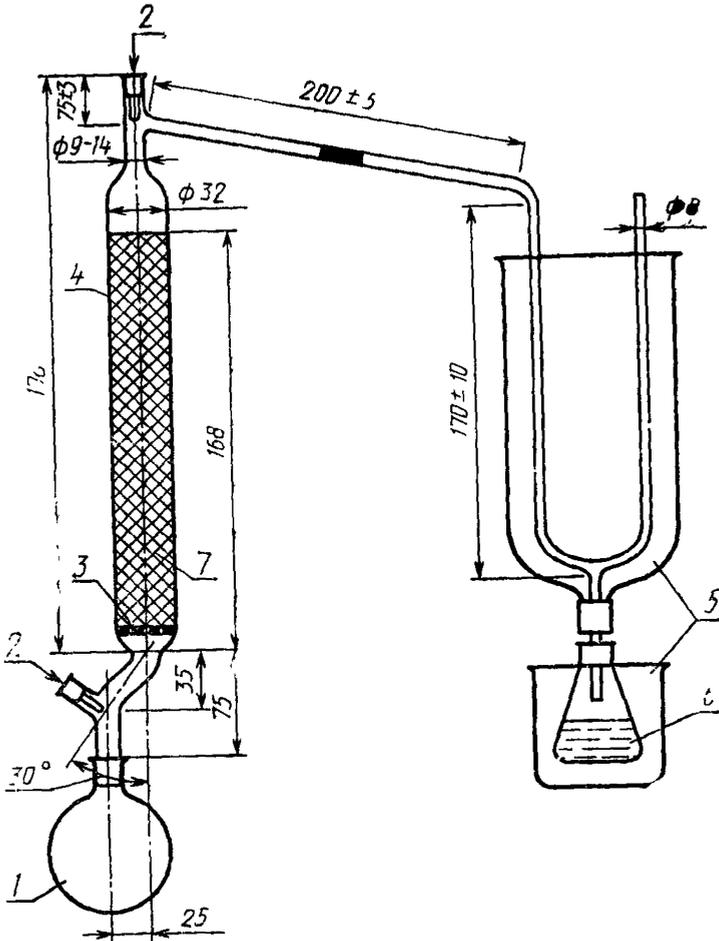
1 — реакционная колба со шлифом вместимостью 500 см<sup>3</sup>; 2 — термометры; 3 — стеклянная решетка; 4 — колонка, наполненная стеклянной насадкой; 5 — охлаждающая баня со льдом; 6 — приемник; 7 — кольца Рашига стеклянные 5×5×0,5
