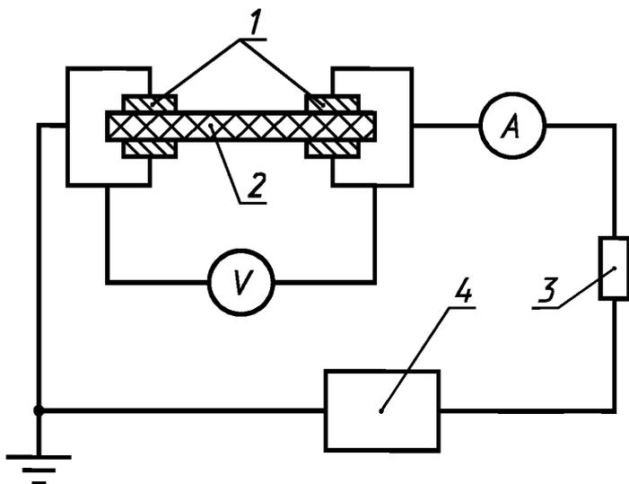
1 — электроды; 2 — образец; 3 — резистор; 4 — источник постоянного напряжения
