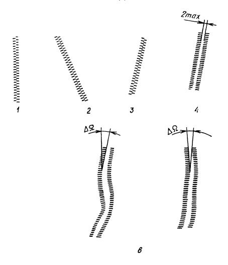
1, 2, 3—отсутствие дефектов; 4—импульсный камень смещен с линии центров «вилка—баланс» при нахождении системы «баланс—спираль» в положении статического равновесия; 6—система «баланс—спираль» неизохронна, периодически меняется амплитуда колебаний баланса;  $\Delta \Omega$ —изменение мгновенного хода.
