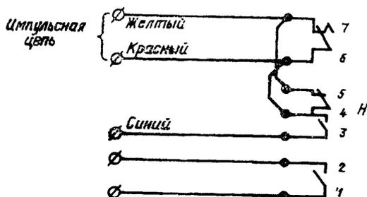
*Н1,2*—шунтирующие контакты (замыкающие накоротко телефон при наборе номера); *Н3,4*—шунтирующие контакты (замыкающие накоротко разговорную цепь при наборе номера); *Н4,5*—шунтирующие контакты (замыкающие накоротко импульсные контакты *Н6,7*); *Н6,7*—импульсные контакты.
