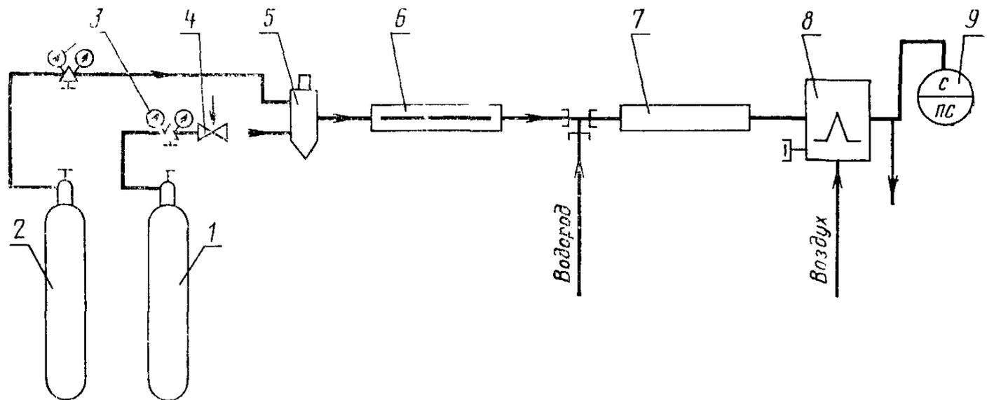
1—баллон с анализируемым газом, 2—баллон с газом носителем, 3—редуктор баллона,
