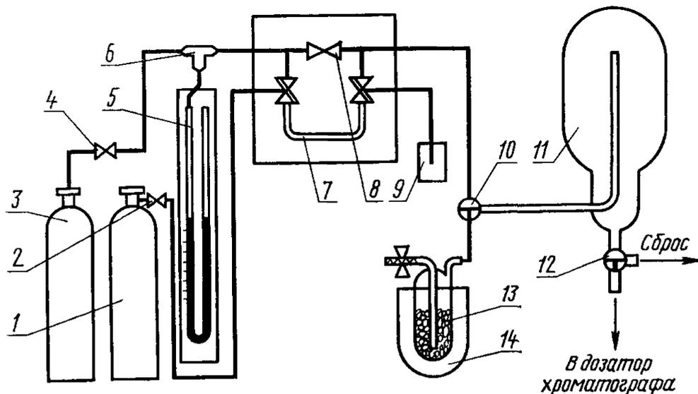
1—баллон с газом-примесью, 2, 4—редуцирующие вентили, 3—баллон с газом-основой, 5—ртутный манометр, 6—тройник, 7—откалиброванная пипетка вместимостью 1—2 см<sup>3</sup> с двумя трехходовыми кранами, 8—кран одноходовой, 9—стакан с водой, 10, 12—трехходовые краны, 11—мерный сосуд для смеси вместимостью около 1 л, 13—ловушка с активированным углем, 14—сосуд Дьюара с жидким азотом.
