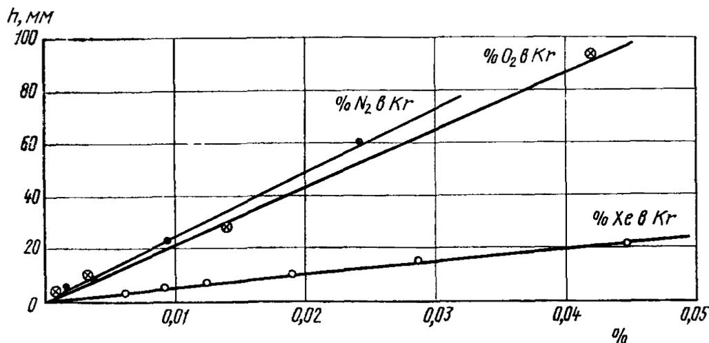
Условия градуировки: детектор по теплопроводности, ток питания 140 мА, газ носитель гелий 20 см<sup>3</sup>/мин. Температура газохроматографической колонки (N аХ, 3,2 м) 60°C.
