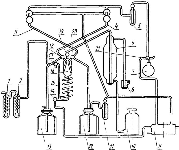
1—2—бурбоветы 3—микробуветка с раствором гидрата окиси бария, 4—микробуветка с раствором соляной кислоты 5—промывалка, 6—астиветор, 7—резиговая груша, 8—ртутный затвор, 9—сливная склянка, 10—уровнительная склянка, 11—защитная склянка, 12—склянка с раствором гидрата окиси бария, 13—склянка с раствором соляной кислоты, 14—17—краны
