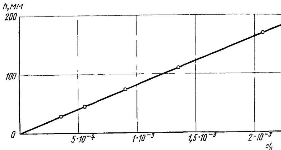
Условия градуировки: детектор ионизационно-пламенный, газ носитель гелий, 20 мл/мин, расход воздуха 150 см<sup>3</sup>/мин, расход водорода 30 мл/мин. Температура газохроматографической колонки (N аХ, 1 м) 60°C
