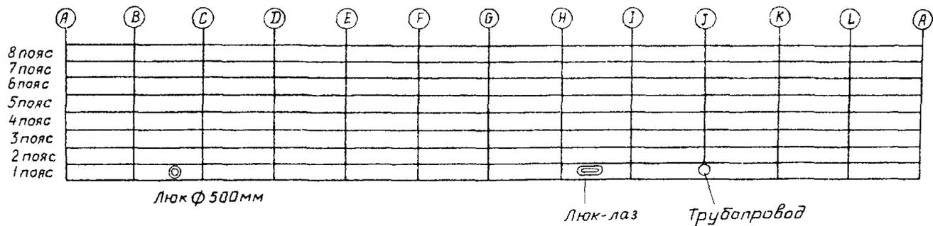
**Рис. 2. Пример карты для обследования стенки бака.**
