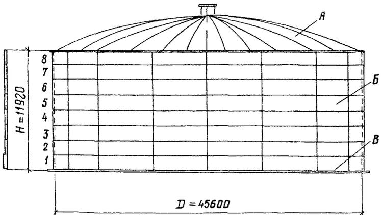
Рис. 1. Общий вид бака-аккумулятора вместимостью 20 тыс. м<sup>3</sup>:
