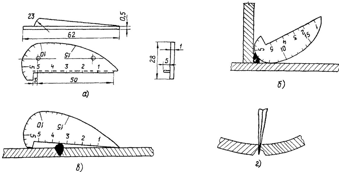
**Рис. 6. Шаблон для измерения габаритных размеров сварных соединений:**
