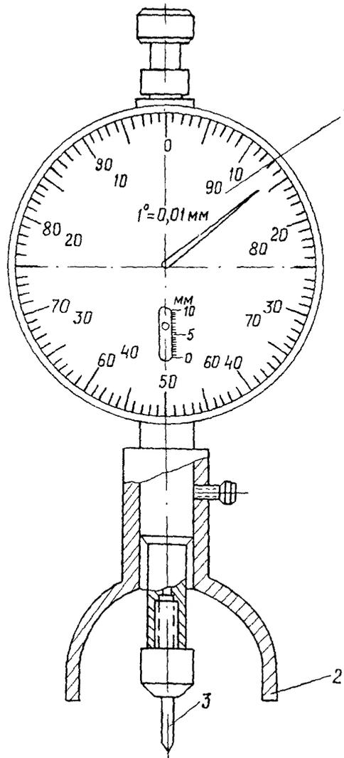
**Рис. 5. Приспособление для определения глубины коррозионной язвы:**
