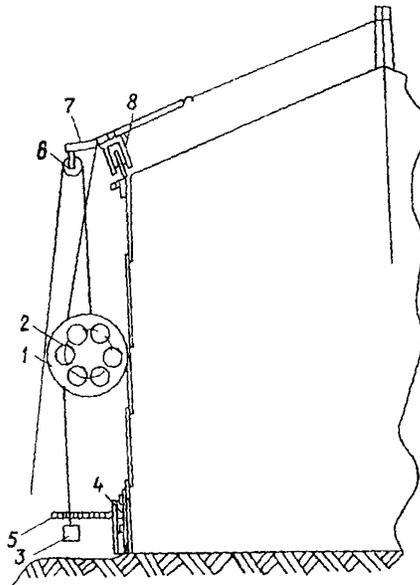
**Рис. 8. Измерение отклонений стенки бака от вертикали с помощью каретки:**
