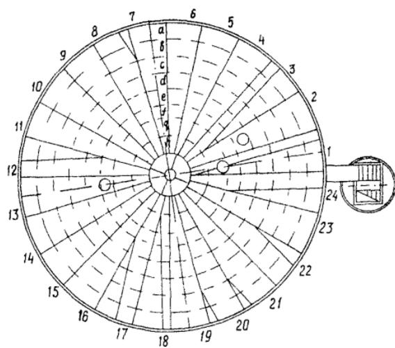
Рис. 3. Пример карты для обследования кровли бака
