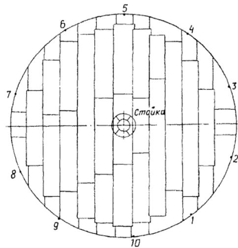
Рис. 4. Пример карт для обследования днища бака
