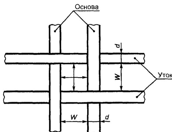
$W$  — размеры ячейки;  $d$  — диаметр проволоки
