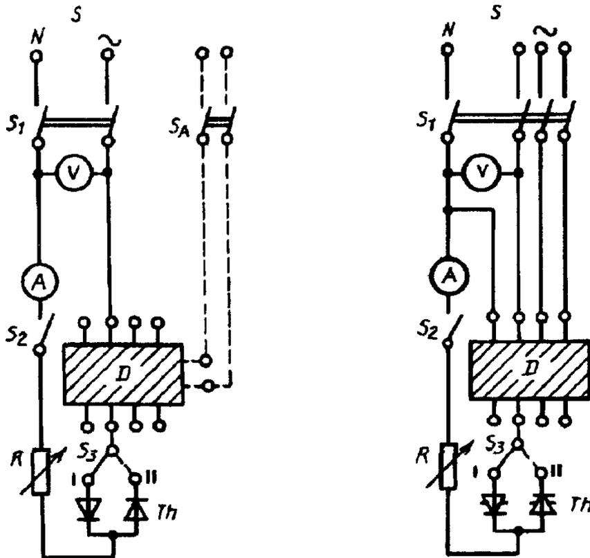
$S$  — источник электрической энергии,  $I$  — независимая линия питания,  $V$  — вольтметр,  $A$  — амперметр (показывающий истинное действующее значение),  $D$  — УЗО — Д, подвергаемое испытанию,  $R$  — регулируемый резистор,  $S_1$  — многополюсный выключатель,  $S_2$  — однополюсный выключатель,  $S_3$  — двухполюсный выключатель на два направления,  $S_A$  — вспомогательный выключатель  $Th$  — тиристоры
