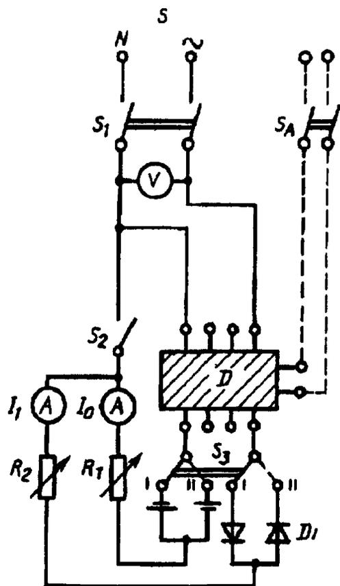
$S$  — источник электрической энергии  $I$  — независимая линия питания,  $V$  — вольтметр  $A$  — амперметр  $D$  — УЗО — Д, подвергаемое испытанию  $D_1$  — диоды  $R_1$  и  $R_2$  — регулируемые резисторы,  $S_1$  — многополюсный выключатель,  $S_2$  — однополюсный выключатель  $S_3$  — двухполюсный выключатель на два направления  $S_A$  — вспомогательный выключатель
