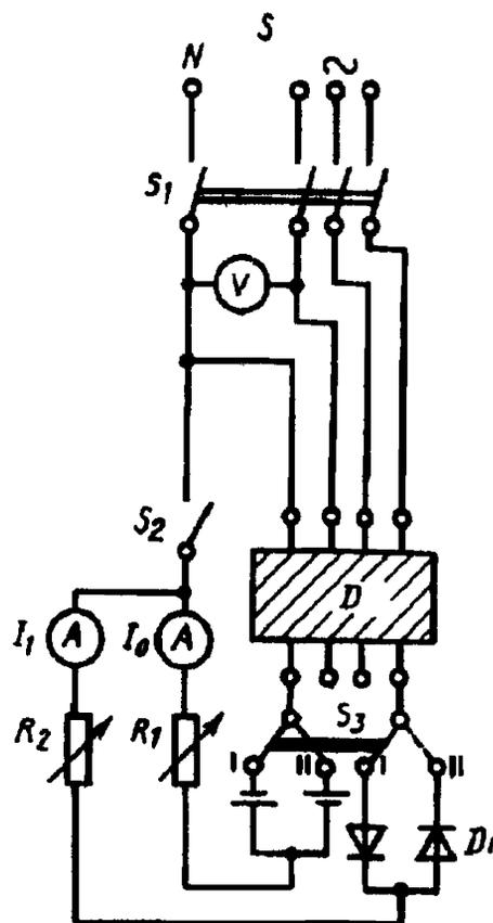
Рисунок 3г — Схема испытательной цепи для проверки правильности отключения УЗО — Д с вспомогательным источником питания, представляющим собой главную линию питания, в случае дифференциального тока со стабилизированной постоянной составляющей
