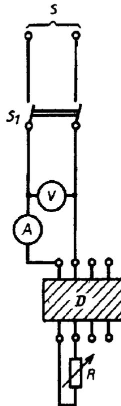
$S$  — источник электрической энергии,  $S_1$  — двухполюсный выключатель,  $V$  — вольтметр,  $D$  — испытуемое УЗО — Д,  $R$  — регулируемый резистор,  $A$  — амперметр  $V$  — вольтметр
