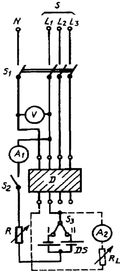
$A_1$  — амперметр постоянного тока,  $A_2$  — амперметр переменного тока,  $D$  — испытуемое УЗО — Д,  $Ds$  — источник постоянного тока,  $R$  — регулируемый резистор,  $R_L$  — активная нагрузка,  $S$  — источник питания переменного тока,  $S_1$  — многополюсный выключатель,  $S_2$  — однополюсный выключатель,  $S_3$  — двухполюсный выключатель на два направления
