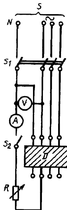
$S$  — источник электрической энергии  $I$  — независимая линия электропитания,  $V$  — вольтметр
